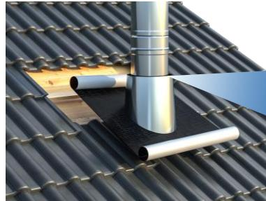
2. Postavite krovni opšav preko dvostjenog dimovodnog sistema i centrirajte ga.
