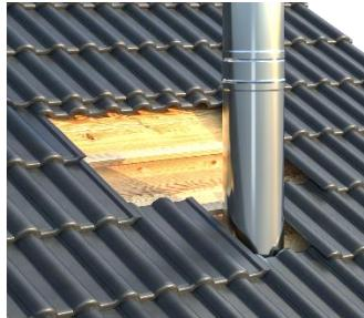
1. Montaža dimovodnog sistema prđorom kroz krov. Dva reda crjepe iznad dimnjaka moraju biti uklonjena.
