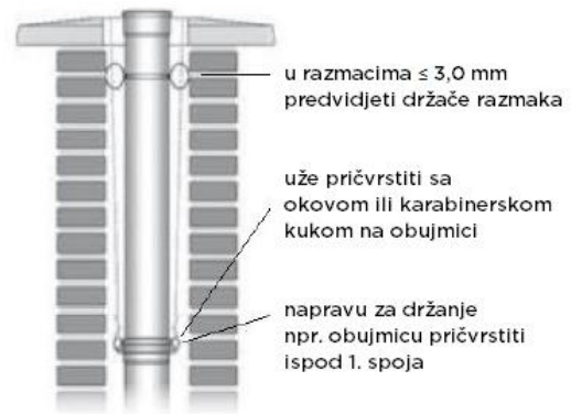
sl. 11, upuštanje cijevi u okno
