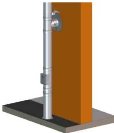
slika 5-8: montaža sa teleskopskim potpornjem
