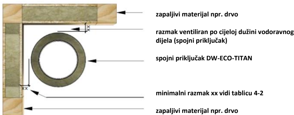
slika 4-2: ugradnja kao spojni priključak do T600
