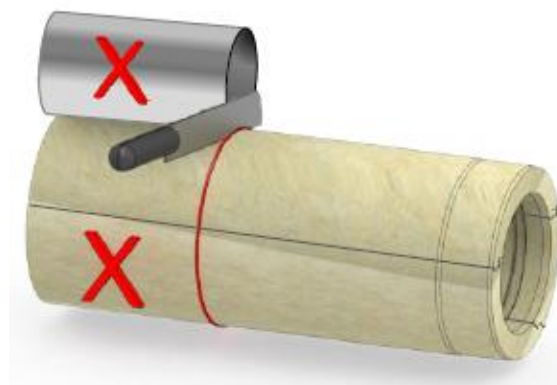
Skratite izolacijske školjke u skladu s unutarnjim dijelom cijevi. Izolacijski prsten (vidi br. 2) se ne smije skratiti.
