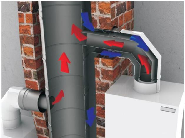
> Priklučci kolektivnih dimnjaka mogu se instalirati kao distributivni sistem uz korištenje Jeremias EW jednostijenih sistema namijenjenih za rad u negativnom tlaku. Ovo rješenje uključuje dimovodne cijevi za ispušne plinove i drugu cijev, koja pruža zrak za izgaranje.
