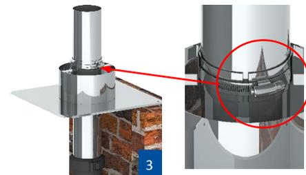
**!** Ist das starre Kunststoffrohr angeschlossen, darf der Schlauchbinder am Klemmband nicht angezogen werden damit sich die Rohrleitung in der Länge ausdehnen kann.
